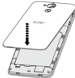
3. Совместите позолоченные контакты аккумулятора с контактами в верхней части отсека аккумулятора и вставьте аккумулятор.
